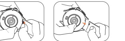
組裝錶帶：請先將彈簧棒的一端插入錶背的彈簧棒孔洞中，然後向後拉動快速插銷，將另一端插入。安裝完成後，請拉一拉錶帶，確定接牢。
